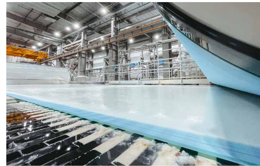
Термомеханическая масса — основа картона и бумаги «КАМА», на двухсеточном прессе БХТММ-2
