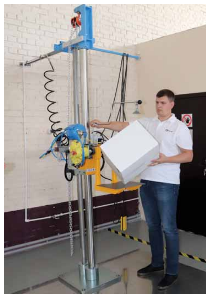
Тестирование коробки путём её сброса с заданной высоты (drop test) в имитационной лаборатории «Готэк»
