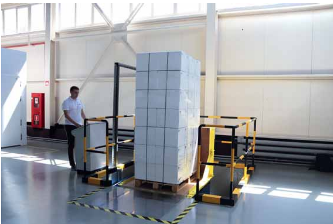
Вибрационные испытания палеты с готовой упаковкой в имитационной лаборатории «Готэк» в Новомосковске
